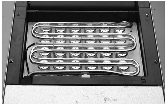
Pour Scale Remover Over The Evaporator Section
